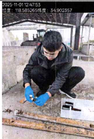
4#地下柴油罐东土壤现场采样
