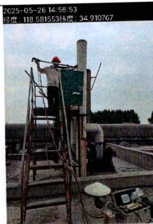
DA010 上料废气排放口 2 现场监测
