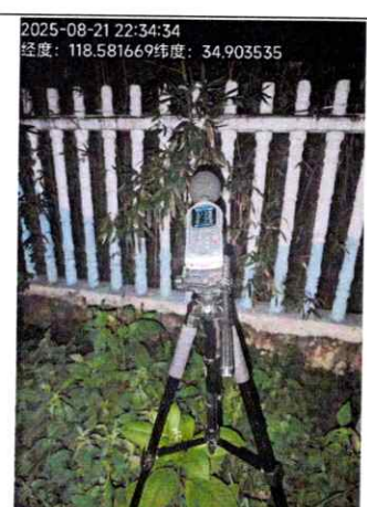
3#西厂界夜间噪声现场监测
