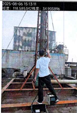
DA001 硫化钡渣无害化反应废气、 带式真空过滤机真空泵尾气排放口 现场监测
