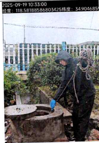
雨水排口现场监测
